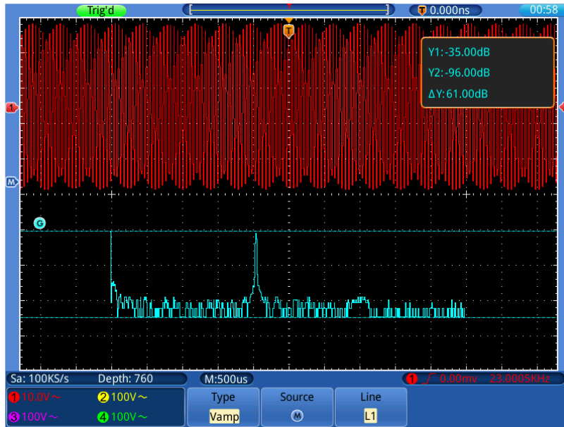
Bild 0-9 Amplituden Cursor-Messung für FFT
