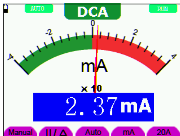
Abbildung 23: Gleichstrommessung <400 mA (DCA)
