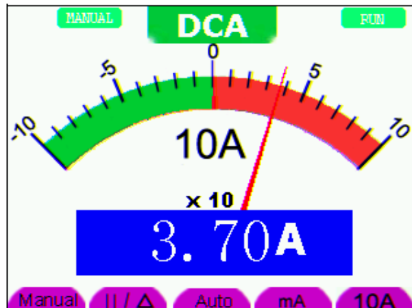
Abbildung 24: Gleichstrommessung <10 A (DCA)
